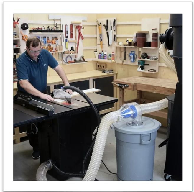
Der IGM Späne- und Staubabscheider trennt grobe Verunreinigungen vom Absaugsystem. Das erhöht dessen Effizienz und Lebensdauer. Anschluss für 100 mm Schlauch. Kompatibel mit allen Arten von Abfallbehältern.
